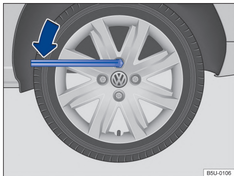
Fig. 204 Cambio de rueda: aflojar los tornillos de la rueda.
