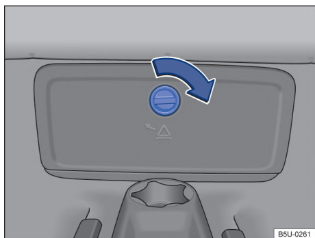
Fig. 162 En el piso del asiento trasero: acceso a la caja de fijación de las herramientas de a bordo.
