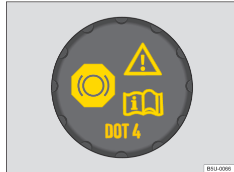
Fig. 192 En el compartimento del motor: tapón de cierre del depósito del líquido de frenos.
