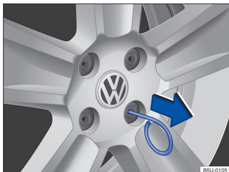
Fig. 202 Retirar las caperuzas de los tornillos de rueda.
