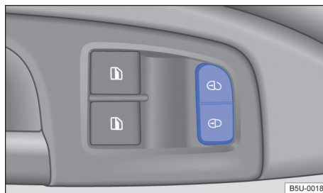
Fig. 42 En la puerta del conductor: tecla del cierre centralizado.
