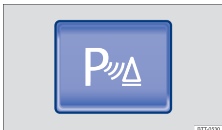
Fig. 88 En la parte superior de la consola central: pulsador para activar y desactivar el control de distancia de aparcamiento (Park Pilot).
