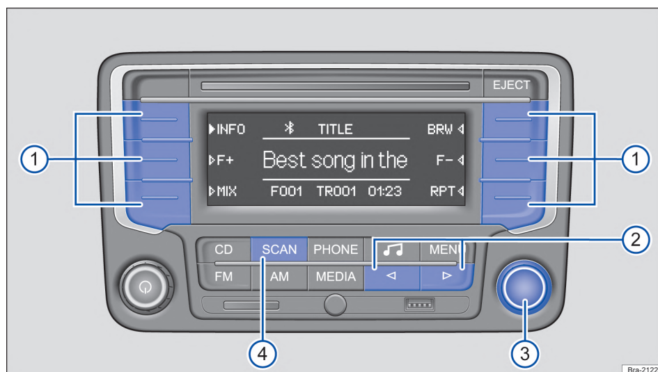
Fig. 145 Ejemplo de visualización en el modo Media: muestra la ubicación de almacenamiento de un MP3 al cambiar de pista.
