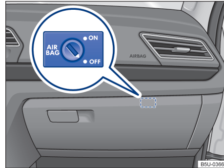
Fig. 35 En la guantera: conmutador desactivado por la llave para apagar y encender el airbag frontal del pasajero.
